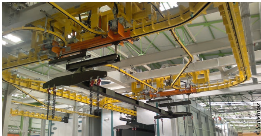
Ein leeres 6-fach-Laufwerk steht in der Beladestation bereit, einen Trailer aufzunehmen. Der Vertikalumsetzer ist in Querrichtung eingebaut.
