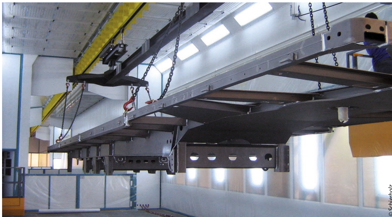
Laufwerk mit Trailer-Chassis in der Grundlackkabine
