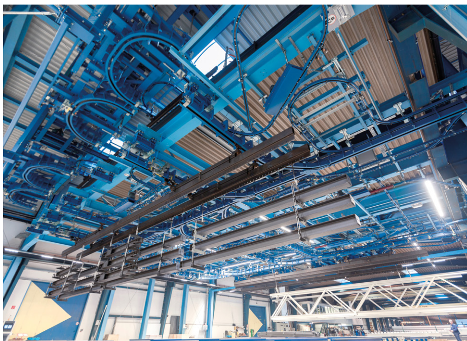
01 Transport von Stahlträgern und Fachwerken
