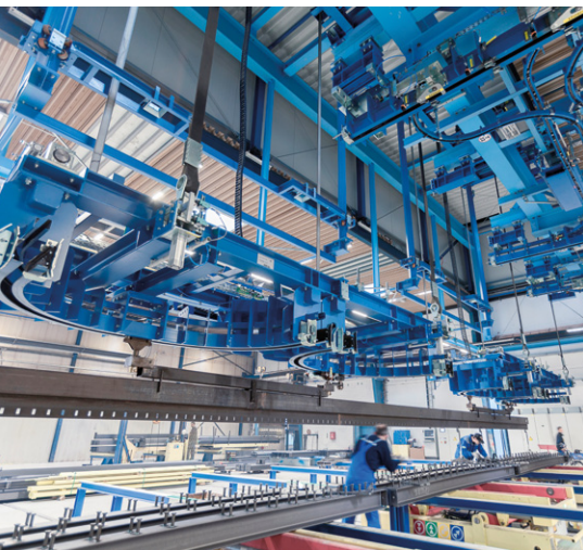
02 Doppel-Vertikalumsetzer mit Lasttraverse im Aufgabebereich
