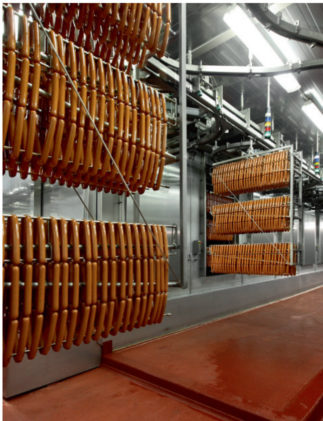
Abb. 1: Ein Transportsystem aus Edelstahl verknüpft die Produktionsschritte ohne menschliche Arbeit.
