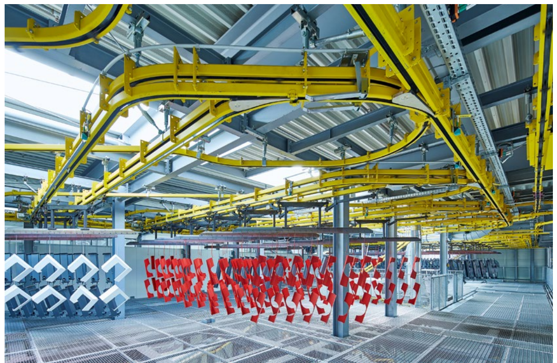
Der gesamte Herstellungsprozess bei Hargassner läuft auf zwei Ebenen ab, hier ein Einblick in den Zwischenspeicher in der zweiten Ebene. Quelle: Schierholz
