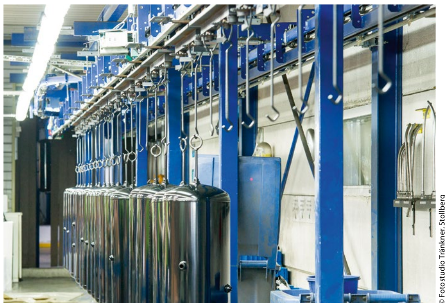
Bild 3 > Beschichtete Druckbehälter im Bereich Endfertigung
