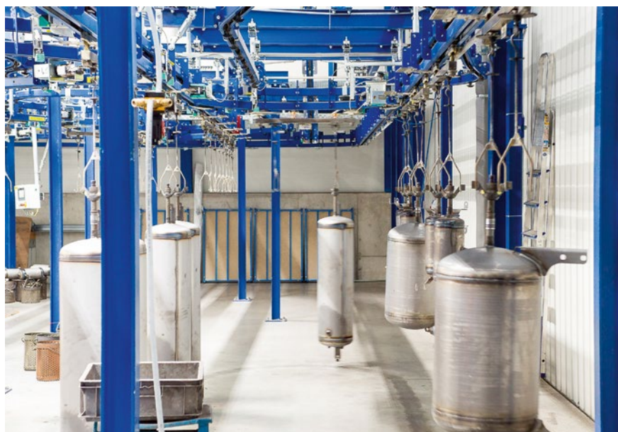
Behälter werden der Druckprüfung zugeführt
