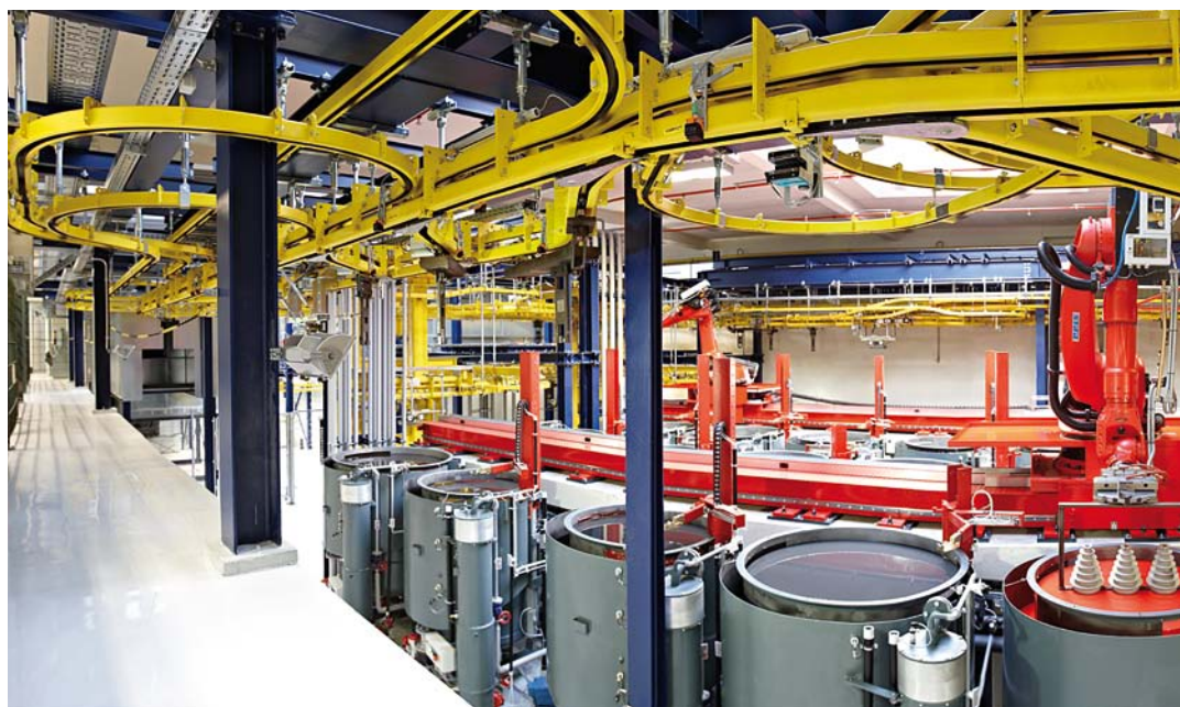
Das Herz der Anlage: Der Tauchbereich mit den Becken und den beiden Tauchrobotern.
