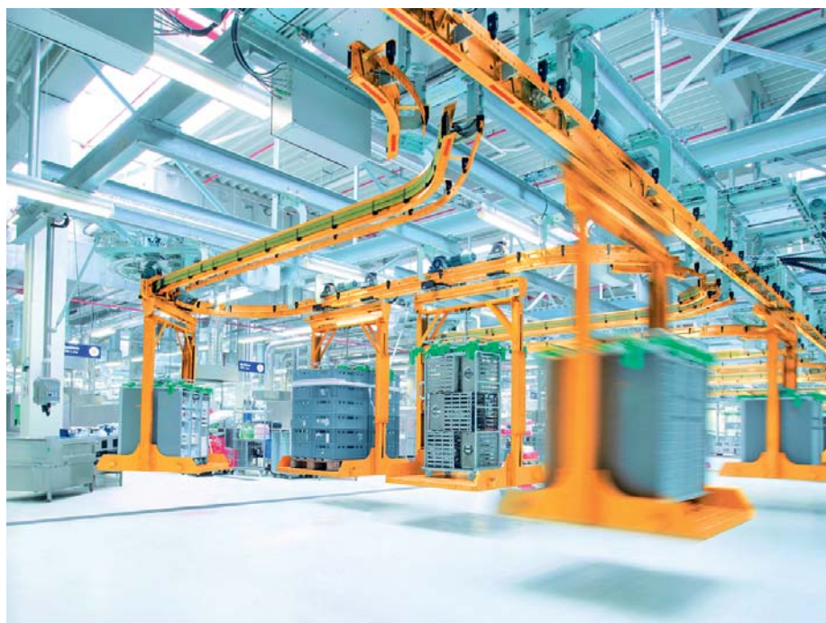
1 Elektrohängebahnsysteme mit flexibler, durchgehender, weltweit verfügbarer Automatisierungstechnik haben sich branchenübergreifend etabliert
