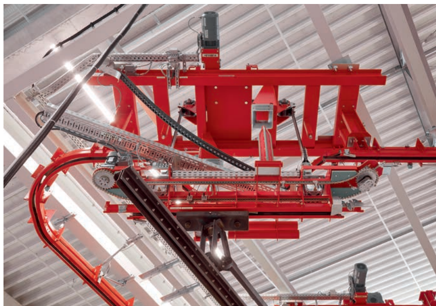
Hub-Senk-Stationen für lange Traversen durch zwei parallele, ungeführte Gurtheber.
