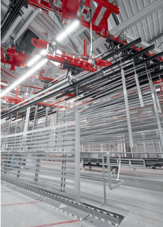
Ergonomisches Be- und Entladen durch Versenkung der Traversen im Bodenschacht.
