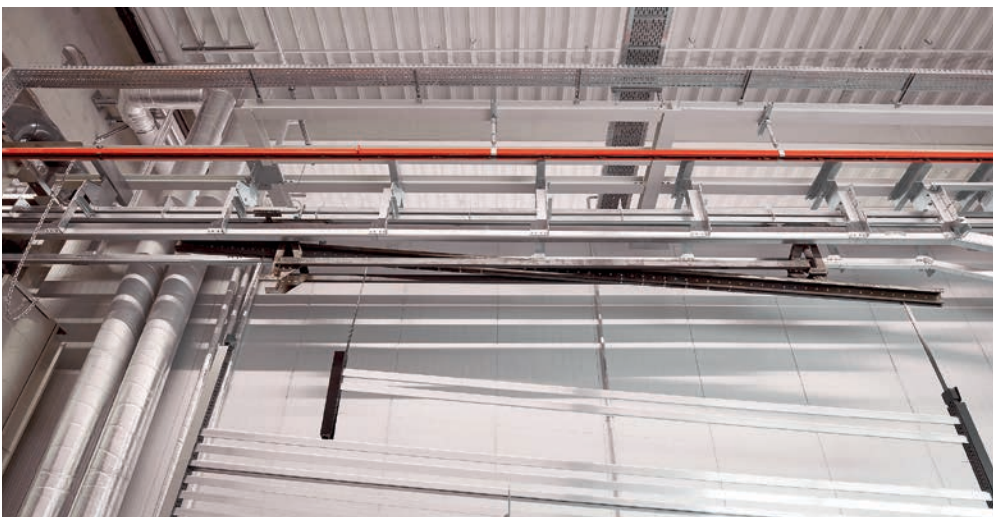
Die Neigung der Traversen reduziert die Medienverschleppung in den Bereichen Vorbehandlung, Haftwassertrockner und Abblaszone.
